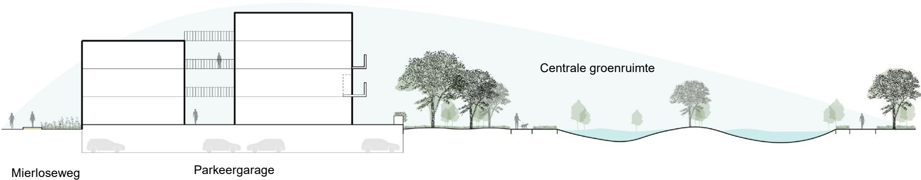
Figuur 13: Dwarsprofiel A: Mierloseweg - groene openbare ruimte
